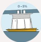
Ermöglicht den Einbau einer genau waagerechten Terrasse auf Böden mit Neigung oder einer geneigten Terrasse auf ebenen Böden.
