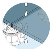
**Offene Fugen** vermeiden im Vergleich zu geschlossenen Fugen die Gefahr von Rissbildungen. **Einfache Wasserableitung.**
