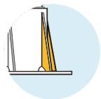
Seitenverstärkungen erhöhen die Stabilität des Stelzlagers.
