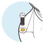
8 Löcher ermöglichen bei Bedarf die Befestigung des Stelzlagers.
