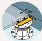
Garantiert einen gleichmäßigen Abstand von 5 mm zwischen der Wand und den Platten und ermöglicht so gutes Abfließen des Wassers am Rand.
