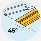
Der Trägerbalken muss im 45°-Winkel zugeschnitten werden.
