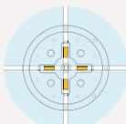
Un seul modèle de croisillons permet de réaliser toutes les configurations de calepinage, grâce aux 4 ailettes facilement détachables.
