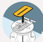
Pour une meilleure stabilité et un meilleur confort acoustique, l'utilisation de l'amortisseur (**U-E10-WALL** ou **U-E20-WALL**) de 1 ou 2 mm est recommandée.
