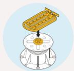
Se fixe sur la tête du plot, sans outil, grâce à l'interface de fixation **PB-KIT-8** pour les **plots PB** (> 28 mm) ou **PB-KIT-8-0-S** pour les **plots PB-0-S** (12 à 28 mm).
