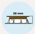
Uniquement compatible avec les **plots PB** à partir de 28 mm (**PB-01** à **PB-11**).
