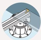
Évite que les arêtes des dalles détériorent les murs et les remontées d'étanchéité.
