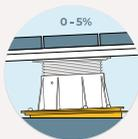
Permet de réaliser une terrasse parfaitement horizontale sur un sol incliné ou de réaliser une terrasse inclinée sur un sol horizontal.
