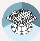
Les ailettes (**U-TABS**) sont à utiliser pour garantir l'espace entre les dalles (2 mm, 3 mm et 4.5 mm).
