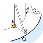
8 orifices à la base du plot assurent un drainage optimal.
