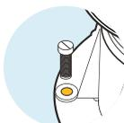
8 orifices permettent la fixation du plot, si nécessaire.
