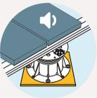
Améliore le confort acoustique dans les pièces de vie qui se trouvent sous la terrasse (pose sur toiture plate).
