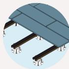
Les lambourdes parfaitement rectilignes facilitent la mise à niveau et présentent un gain de temps important lors de l'installation.
