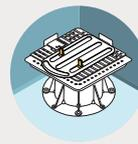
Die Flügel (**U-TABS**) dienen dazu, den Abstand zwischen den Platten zu sichern (2 mm, 3 mm, 4,5 mm).
