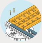
Der untere Teil des Rostes wird auf das Stelzlager oder den Trägerbalken geschraubt, dann wird der obere Teil darauf gelegt.
