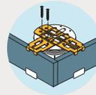
Die Teile lassen sich nach dem Einstellen ins Stelzlager hineinschrauben.
