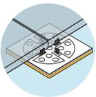
Die Schutzunterlagen U-PAD-GROUND selbst sind nicht höhenverstellbar. Die gewünschte Höhe kann durch die Kombination der Schutzunterlage U-PAD-6 mm, den Schutzunterlagen **U-PAD-GROUND** (3 mm, 6 mm oder 10 mm) und den Ausgleichsscheiben **U-E10** (1 mm) oder **U-E20** (2 mm) erreicht werden.
