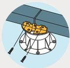
Wird in die Mitte auf einen ganzen Trägerbalken und bei einer Verbindung von zwei Trägerbalken an den Enden eingeschraubt.
