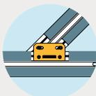
Installation in Winkeln zwischen den Aluminiumschienen zwischen 90° und 45°.
