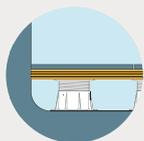
Mit den Aluminiumschienen ist eine Auskragung möglich, was den Abschluss der Terrasse erheblich vereinfacht und beim Einbau einen großen Zeitgewinn bietet.
