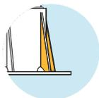
Seitenverstärkungen erhöhen die Stabilität des Stelzlagers.
