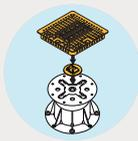
Wird – ohne Werkzeug – mit der Universalbefestigung **PB-KIT-8** auf dem Stelzlagerkopf befestigt.
