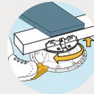
Die Installationshilfe für U-PH5 (**U-PH5-KEY-FOOT**) erlaubt es, die Ausrichtung des Neigungsausgleichers während der Höheneinstellung des Stelzlagers beizubehalten.
