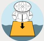
Ermöglicht das Verlegen von Stelzlager auf Böden mit unebener Oberfläche wie Rohbeton.
