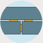
Mit ein und demselben Fugenteilermodell können sämtliche Verlegekonfigurationen realisiert werden, und zwar dank der vier leicht abnehmbaren Flügel.
