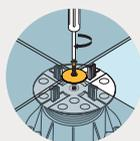
Die Sicherungsscheiben werden mithilfe der **U-WASHER-VIS**-Schrauben befestigt.
