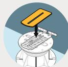
Für eine bessere Stabilität und höhere Trittschalldämmung wird der Einsatz des Ausgleichers (**U-E10-WALL** oder **U-E20-WALL**) mit 1 oder 2 mm empfohlen.
