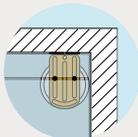
Dank flexibler Flügel passt sich der Träger für Abschnitte jeder Art von Wand an: rechtwinklig, gekrümmt usw.
