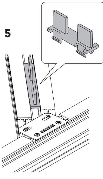
Verrouillage des rails avec U-BRS-TOP-LINK
