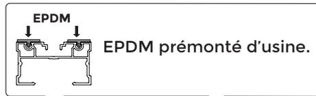
EPDM pré-monté d'usine.
